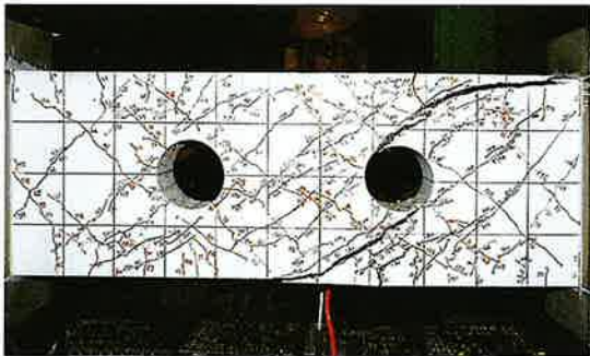
写真2 開孔部のひび割れ状況 (破壊時・2開孔)
