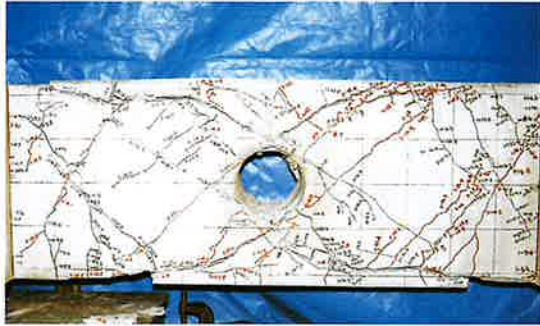
写真1 開孔部のひび割れ状況 (破壊時・1開孔)
